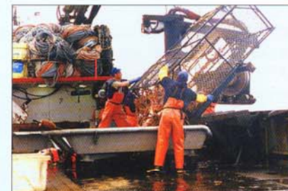
Фото 100. Столик наклоняется и улов высыпается на сортировочный стол.
