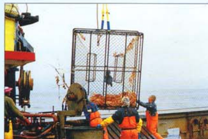
Фото 96. Ловушка вывешивается над опрокидывающимся столиком...
