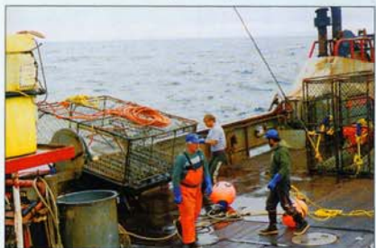
Фото 92. Ловушка готова к спуску. Сверху уложен буйреп. Ловцы готовят буй.
