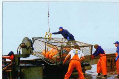
Фото 90. Ловушку укладывают на поворотный столик.
