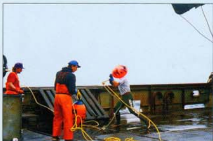
Фото 95. Вслед за ней выбрасываются буй. Большой буй поддерживает буйреп, маленький держит на плаву конец с петлей. Петлю вылавливают кошкой при выборке ловушек.
